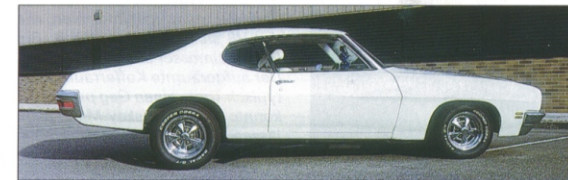
Die 50-mm-Tieferlegung und die Hi-Jacker sorgen für die typische Keiloptik
